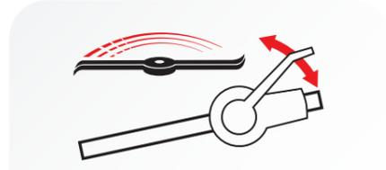
An Bord des SABO 54-K VARIO B: Nach dem Loslassen des Sicherheitsbügels, stoppt das Messer. Der Motor läuft weiter und Sie fahren den Mäher ohne Mühe zum Entleeren des Fangsacks.
